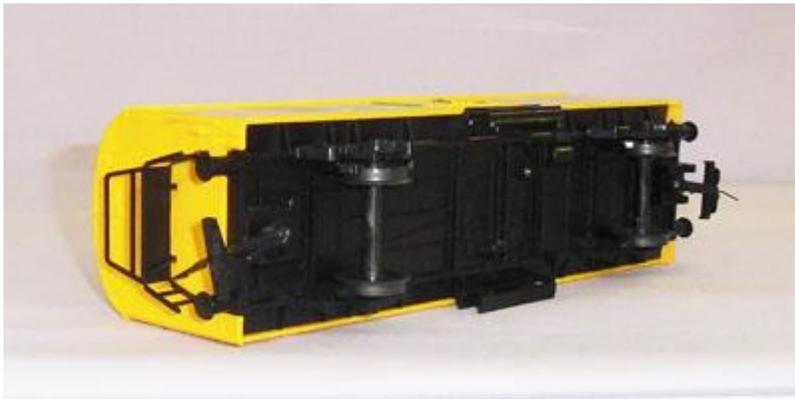
Die angespritzten Griffstangen in Kunststoff werden ans Gehäuse entfernt und durch 0.8 mm Draht ersetzt.
